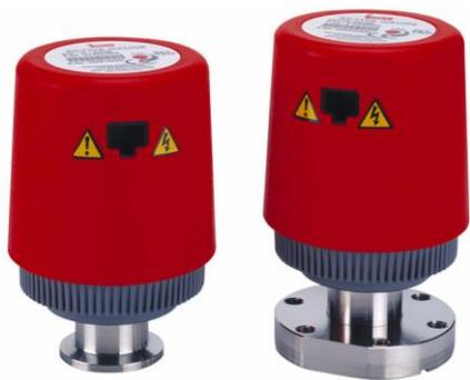
Вакуумные инверсно-магнетронные датчики AIM – это датчики с холодным катодом, предназначенные для измерения давления в диапазоне от  $10^{-2}$  мбар до  $10^{-9}$  мбар. Они обладают высокой надежностью и чрезвычайно компактны.
