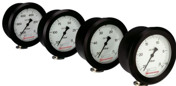
CG16K – это стрелочные барометрически скомпенсированные вакуумметры, предназначенные для измерения низких абсолютных давлений. Атмосферное давление не влияет на показания прибора. Результаты измерений вакуумметра также не зависят от рода газа и его молекулярного состава. Линейка стрелочных вакуумметров CG16K включает в себя несколько моделей, которые предназначены для измерения давлений в различных диапазонах.
