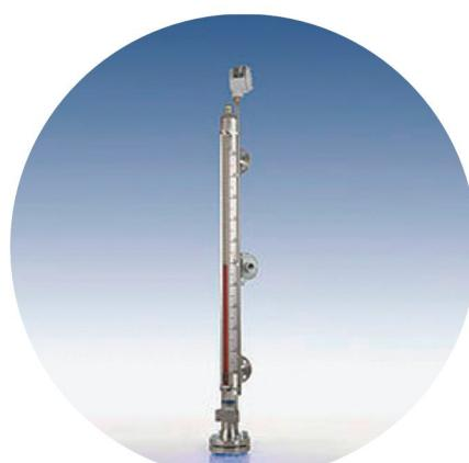
Магнитные датчики уровня Brooks имеют герметичную камеру измерения, изготовленную из нержавеющей стали, ПВХ, РРН, PVDF или PTFE, которая и позволяет надежно измерять уровень различных жидкостей, включая агрессивные, токсичные и прочие. Поплавок является единственной подвижной частью приборов, что делает их исключительно надежными и долговечными. Доступно несколько вариантов подключений.
