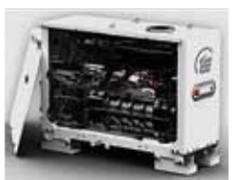
Другое техническое достижение компании – линейка форвакуумных спиральных насосов серий XDS и nXDS, обеспечивающих "безмасляную откачку" до  $7 \cdot 10^{-3}$  мбар с быстротой действия от 1,7 до 26,4 л/с. Основное отличие этих насосов от присутствующих на рынке аналогов заключается в герметичном разделении с помощью сильфонного ввода рабочей камеры и приводной части. Эта конструкция вакуумного ввода запатентована компанией Edwards.
