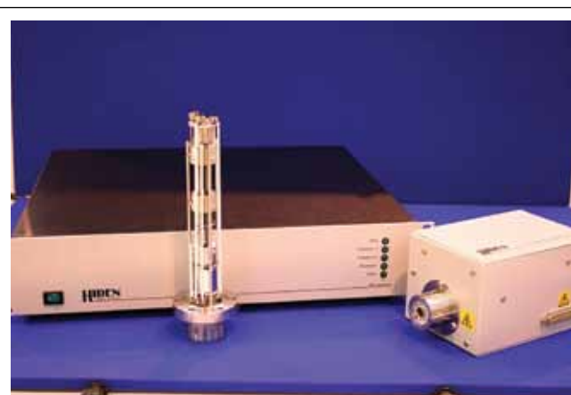
Общий вид системы RGA General view of RGA system
