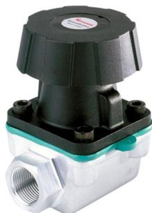
Диафрагменные вакуумные проходные клапаны SP (speedivalve) – это простые и удобные устройства, позволяющие перекрывать вакуумный трубопровод вручную. В корпусе клапанов установлена эластичная диафрагма, которая прижимается к полированному седлу посредством вращения ручки клапана.
