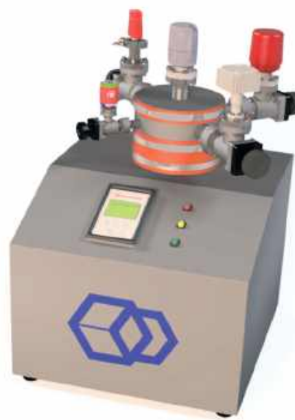
Многопозиционная установка проверки и калибровки вакуумных датчиков
