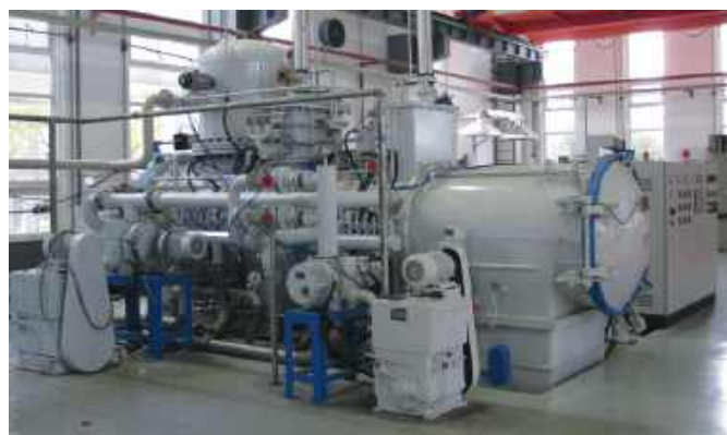
Трехкамерная печь – камера нагрева, камера закалки газом 6 бар и камера закалки в масле
