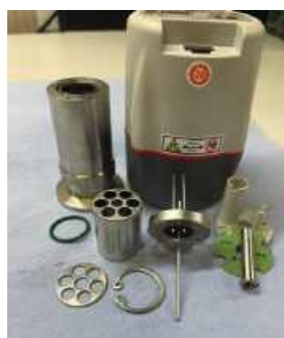
Датчик WRG после проведения регламентного обслуживания и ремонта
