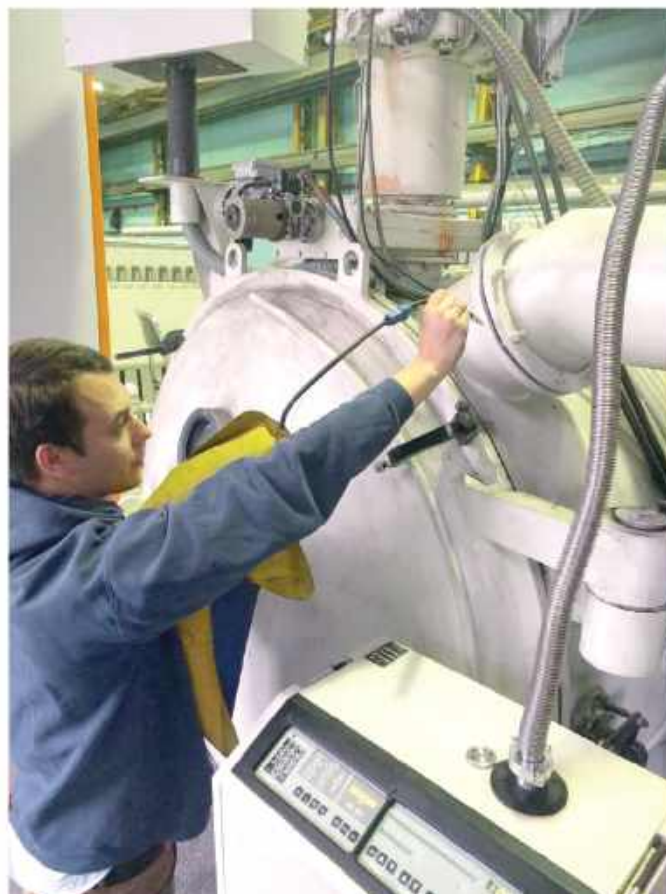
Проведение течеискания методом обдува
