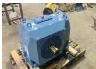
Редуктор после кап. ремонта
