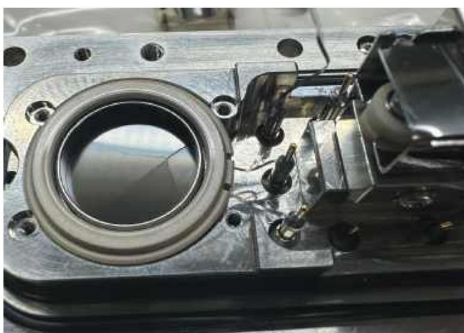
Трещина в мишени анализатора течеискателя MS40
