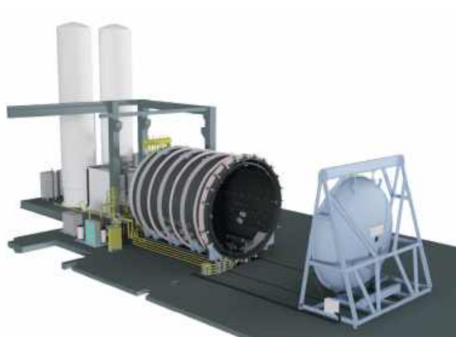
Термовакuumная камера объемом 900 м 3
