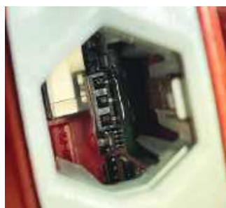
Дефектация датчика APG. Залив трубки и блока электроники маслом
