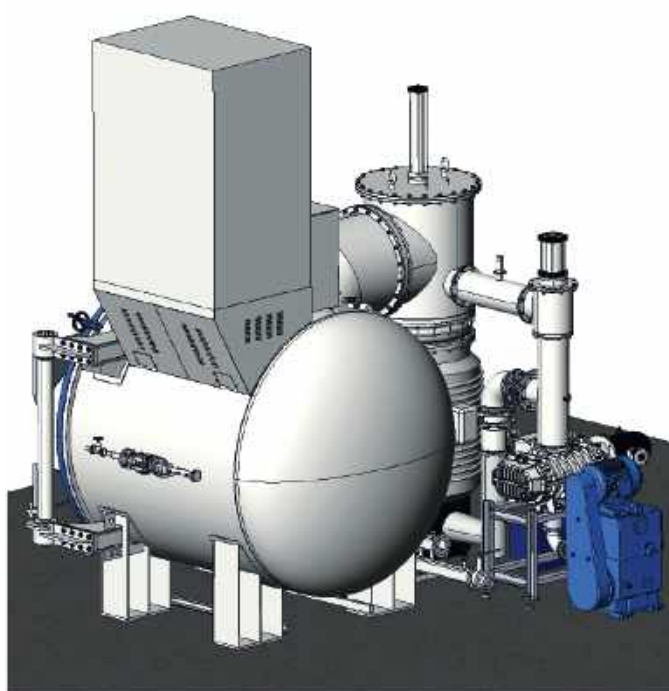
Вакуумная печь с нагревом до 1030 градусов
