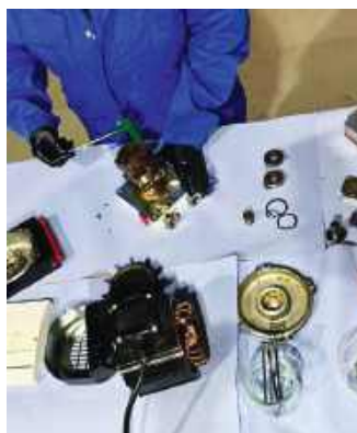
Дефектация насоса Pfeiffer DUO 2.5
