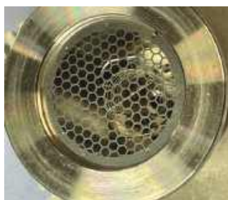
Измерительная трубка AIGX после регламентного обслуживания
