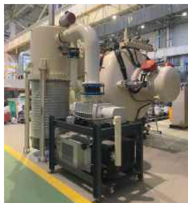
Вакуумная печь с размерами камеры 1000x1500x1200 (ШxДxВ)
