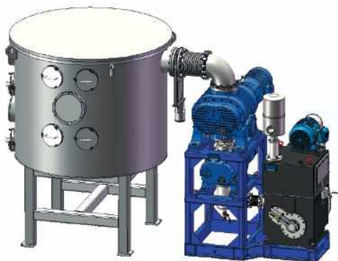
Откачная система установки ЭЛС объемом 2 м 3
