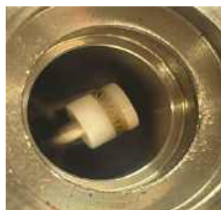
Дефектация датчика APG. Залив трубки и блока электроники маслом
