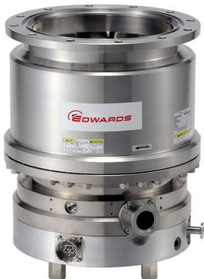
STP-XA2703C – это вакуумные безмасляные турбомолекулярные насосы с магнитным подвесом ротора. Они предназначены для сухой высоковакуумной откачки парогазовой смеси из рабочих объемов. Турбомолекулярные насосы модели STP-XA2703C обладают высокой пропускной способностью и способны работать при высокой газовой нагрузке.
