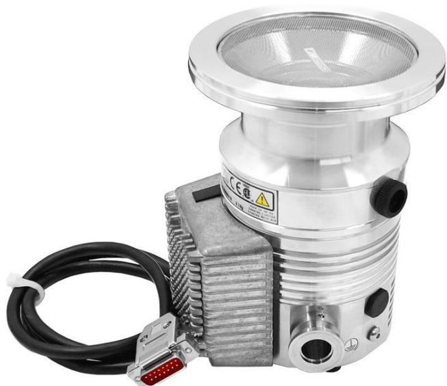
EXT75DX – это гибридный турбомолекулярный насос, объединяющий в себе проверенные технологии нижнего керамического подшипника, сухого магнитного верхнего подшипника и ступень Хольвека. EXT75DX имеет встроенный 24В контроллер, который как параллельно, так и последовательно совместим с TAG и TIC контроллерами. Насос доступен для заказа с любым из DN40NW, DN63ISO, DN63CF или DN100ISO входным фланцем с быстротой откачки азота до 66 л/с.
