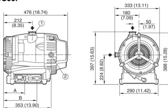
Размер А: расстояние до ручного выключателя
